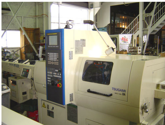
NC旋盤（B社工場、切削油ミスト排気装置未設置）
