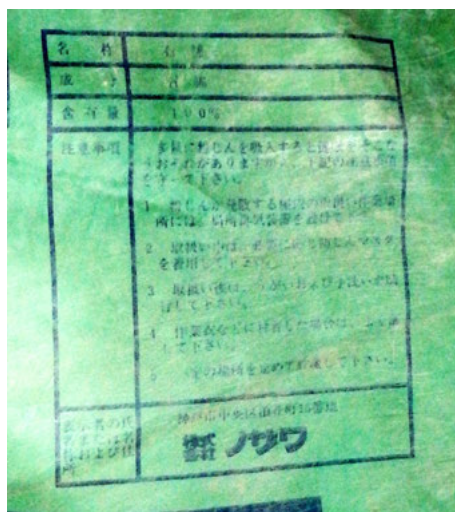
パッケージに「名称石綿 成分石綿 含有量 100% ノザワ」と記載 (写真提供外山尚紀氏) tos01.pdf から引用した。
