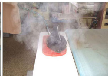
このような状態では石綿ばく露は皆無でしょう。ただしクリーニング店には、この他に乾燥機など断熱材の使用箇所はかなりあり、劣化による飛散や、修理・補修時等のばく露の可能性もあります。
