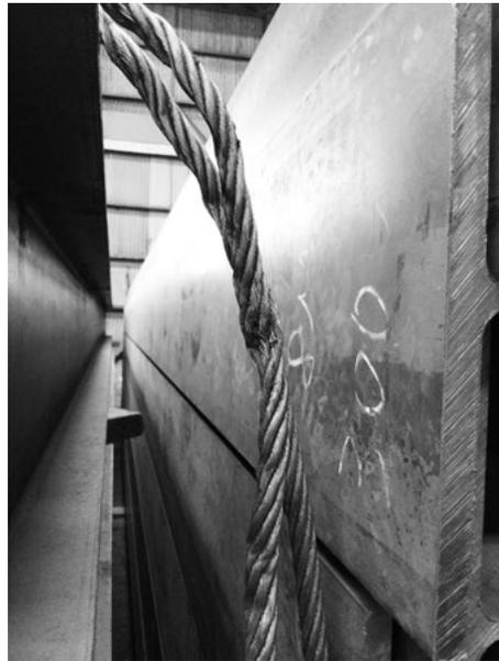
ように保護（５）ドラム及びロープ社に接する部分で断線している素線は、ストランドの谷部から折って取り除く（６）末端部に異常が認められた場合は、補修又は切り詰め、あるいは必要に応じて天地振替を行う（７）クリップにゆるみが
