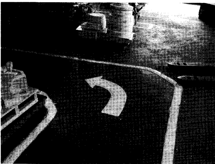
(写真:きれいにひかれた安全通路)
