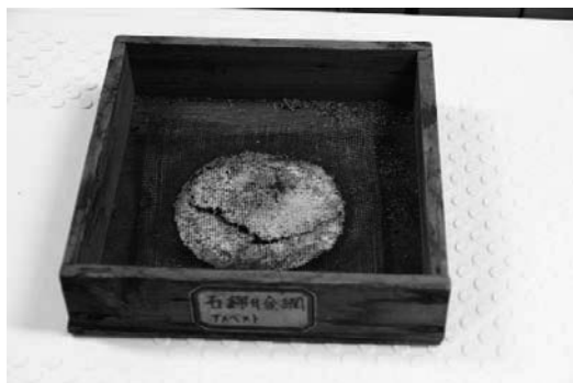
写真1：中央部分が分離した石綿付金網
